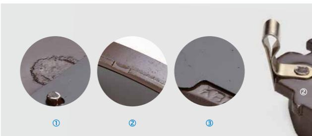
Рис. 4. Фрикционная пластина может расслоиться, плохо читаемая гравировка, неоригинальные колодки имеют неровные края
