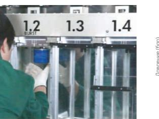
Рис. 1. Для масляных фильтров используют специальный тест на герметичность
