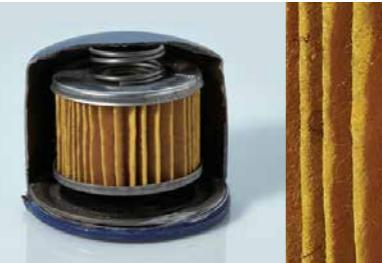
Рис. 6. Материал неоригинального фильтра неравномерно склеен с торцевыми пластинами фильтра, из-за дешевого материала фильтровальная бумага легче
