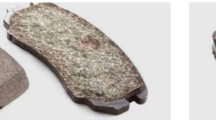
Рис. 1. Оригинальные накладки тормозных колодок спрессованы под высоким давлением, более тяжелые, с гладкой поверхностью, с четко выраженным цветом
